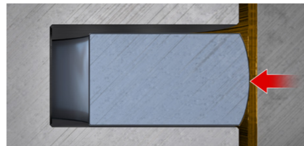
Rys. 2: Baryłkowatość symetryczna powierzchni bieżnej pierścienia
