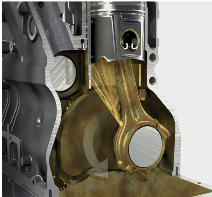
Rys. 1: Otwory wytryskowe oleju w korbowodzie zapewniają smarowanie powierzchni bieżnej
