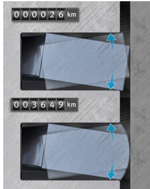
Rys. 1: Baryłkowatość wskutek zużycia podczas docierania
