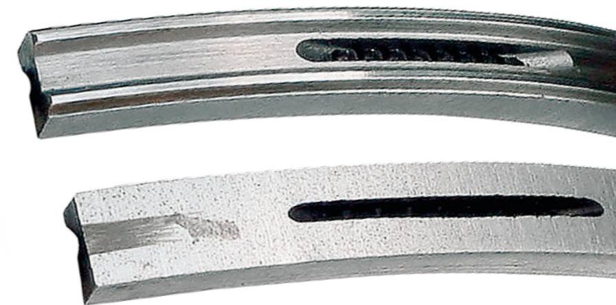
Rys. 3: Nowy i zużyty pierścień zgarniający olej
