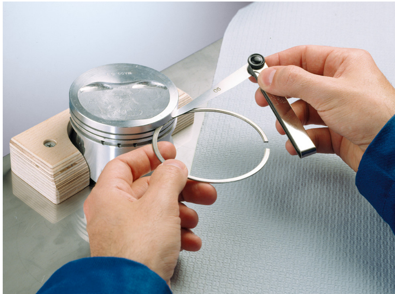
Rys. 1: Pomiar luzu pionowego pierścienia
