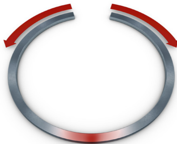
Rys. 1: Nadmierne rozgięcie pierścienia tłokowego
