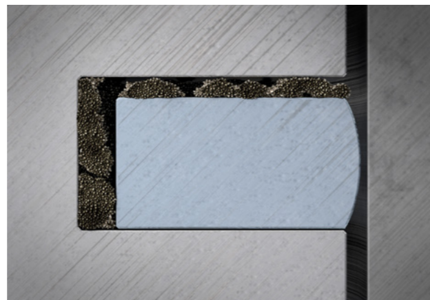
Rys. 1: Osady brudu w rowku pierścieniowym
