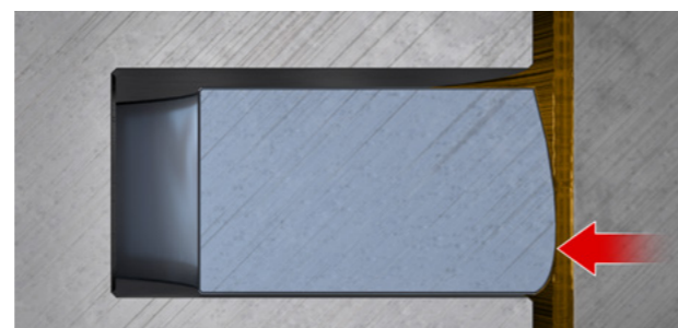
Rys. 3: Baryłkowatość asymetryczna powierzchni bieżnej pierścienia
