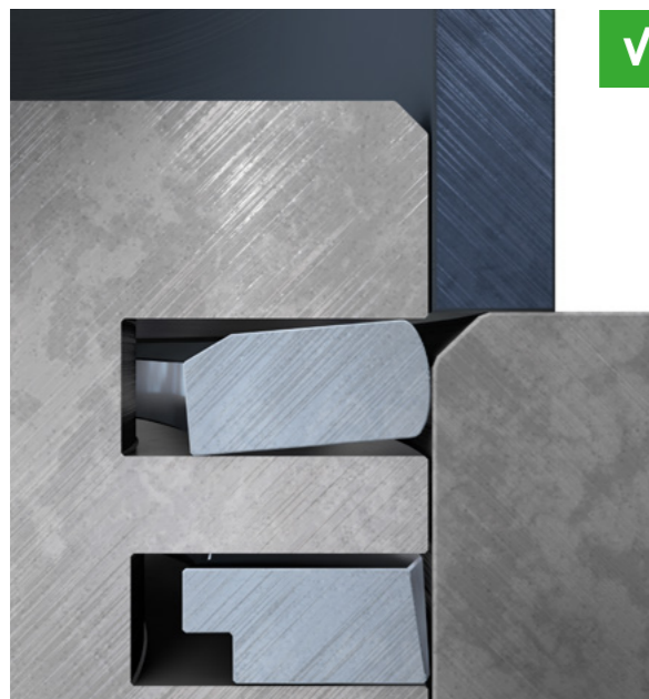
Rys. 2: Mały skos otworu cylindra – pierścień tłokowy ślizga się nad szczeliną
