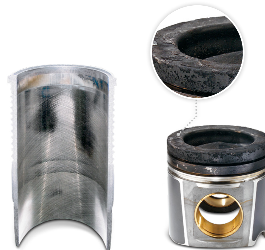
Rys. 2: Wybłyszczenia i miejsca polerowane w górnej części cylindra
